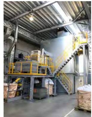
PETECKの「エアコン熱交換器コンパクト破碎選別システム」
