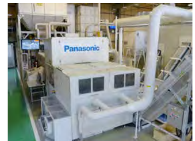
3種の樹脂を同時に選別できる近赤外線樹脂選別機
