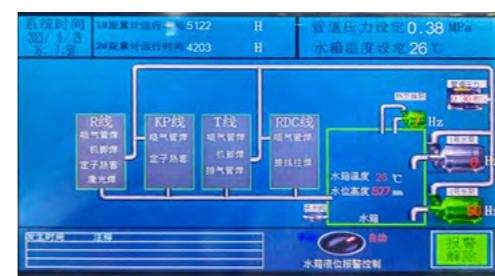
松下·万宝(广州)压缩机有限公司二厂的壳体生产设备冷冻水原采用分散式对应，致使运行成本和现场温度较高(温度涨幅1-2℃)。通过分析改进，公司利用冷冻机富裕能力集中供应，替换原有的15台冷水机组，有效减少了能源消耗，降低了运行成本。
