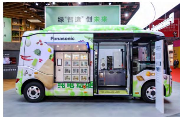
推出搭配松下低 GWP ( 全球升温潜能值 ) 冷媒制冷设备的纯电动移动售卖车解决方案，环保节能效果显著，为移动便利零售带来新思路与形态。
