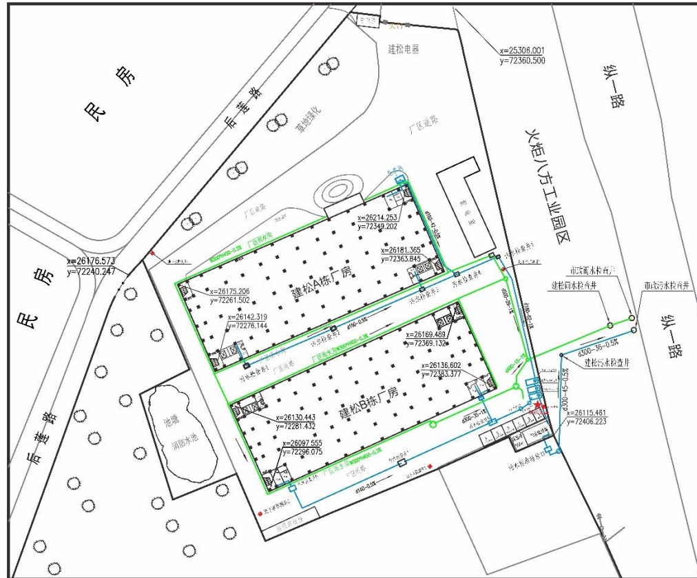
厦门建松电器有限公司雨污管网图
