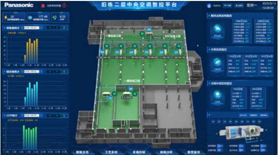
空调能源监控系统
