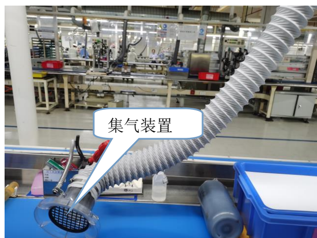
焊接废气收集装置
