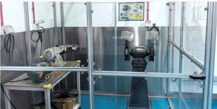
较大动能机械安装安全防护罩
